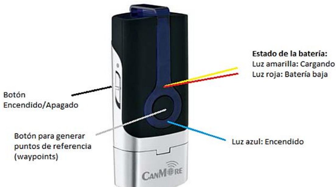
Figura 5. Parte anterior de un tracker modelo Canmore donde se observa el botón de encendido.
