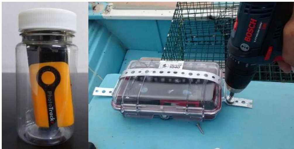
Figura 6. Cuidar el tracker y evitar que se moje con agua de mar ayudará a alargar la vida del aparato.
