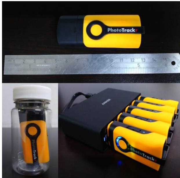
Figura 3. Dispositivo tracker USB marca Canmore utilizado por el Programa Marino del Golfo de California para generar información espacial relacionada a la pesca artesanal.
